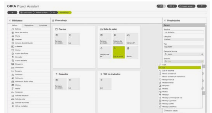
4. Diseño de interfaz: mediante la función de arrastrar & soltar, las funciones de domótica inteligente se pueden ordenar en el GPA del mismo modo en que más tarde se mostrarán en los dispositivos móviles. Más de 300 pictogramas de Gira permiten identificar de manera individual las partes del edificio y las funciones.
