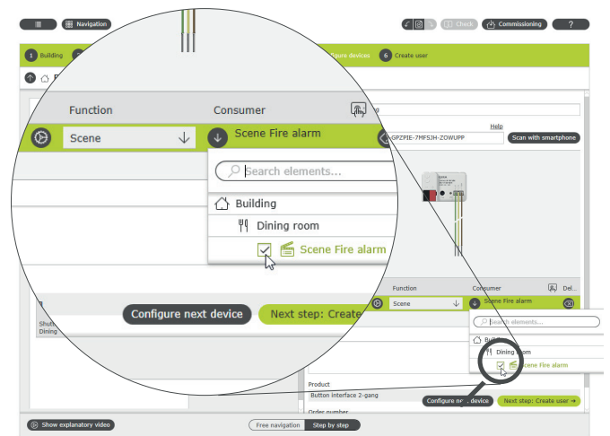
Assegnazione della scena "Incendio" all'ingresso dell'interfaccia pulsanti
