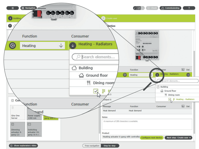
Selezione della funzione "Riscaldamento" e assegnazione dell'utenza
