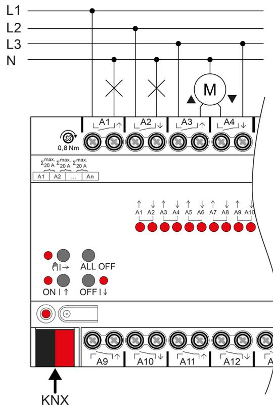
Bild 2: Geräteanschluss (Anschlussbeispiel)
