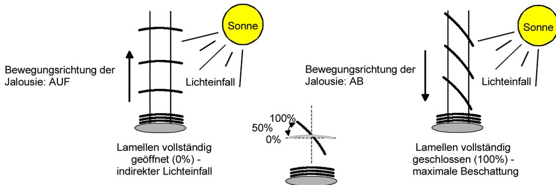
Bild 8: Typ 2 - Lamellenjalousien mit schräger und gerader Lamellenstellung
