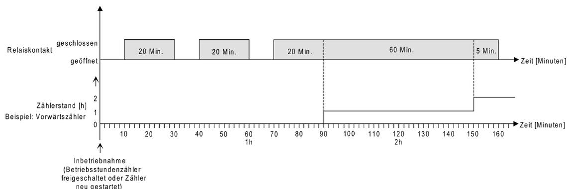
Bild 30: Funktionsweise des Betriebsstundenzählers (am Beispiel gezählter Stunden)
