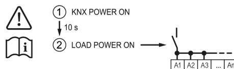
Bild 4: Reihenfolge bei der Inbetriebnahme
