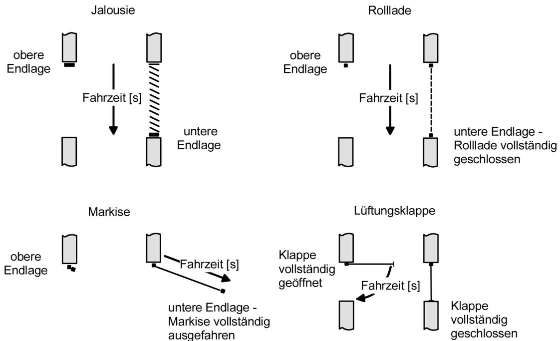
Bild 6: Ermittlung der Fahrzeit in Abhängigkeit der Antriebsart
