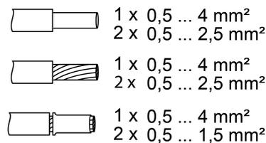
Figure 4: Section transversale de conducteur pouvant être bloquée
