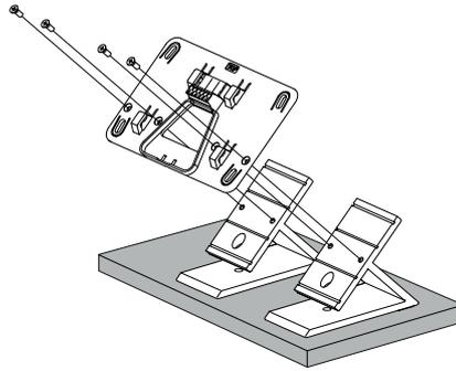
2. Voer de kabel door de afdekking aan de achterkant ende montageplaat.
