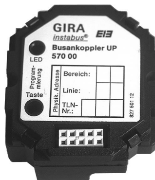
Шинный контроллер без опорной пластины
