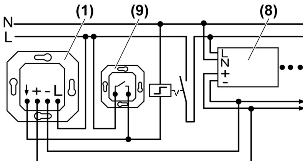
Imagen 5: Esquema de conexiones del potenciómetro con función de pulsación y estación auxiliar
