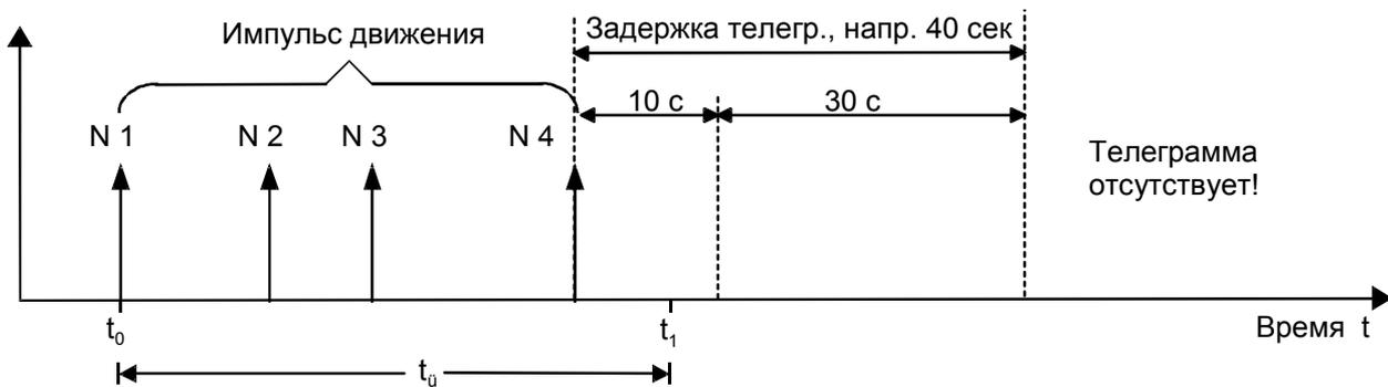
⇒ После регистрации 4-ого импульса движения ( $x = X$ ) в заданном интервале времени  $t_0$  начинается отсчет времени задержки отправки телеграммы. Если за 30 секунд до окончания этого времени не регистрируется ни одного нового импульса движения, то после окончания задержки телеграмма с сообщением о начале регистрации не отправляется!
